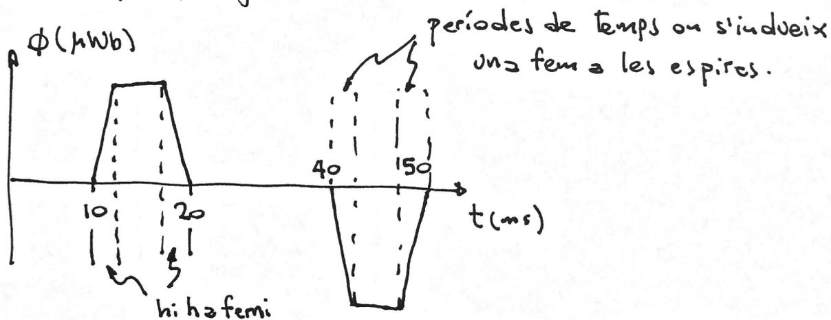
La fem s'induirà durant els períodes de temps on el flux varia, é a dir, entre els 10 i 12 ms, entre els 18 i 20 ms, entre els 40 i 42 ms i entre els 48 i 50 ms.
