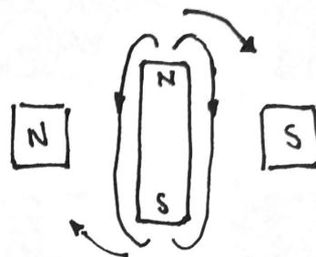
La barra es mouirà en sentit horari, ja que per la regla de la mà dreta podem deduir que el pol nord s'establirà en l'extrem posterior de la barra. El pol sud de l'imat permanent atreurà el pol nord de la barra que pot girar al voltant de l'eix vertical
