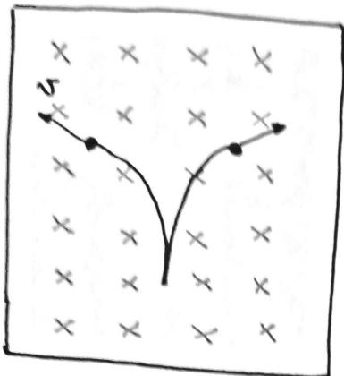
Creació electró - positró en una cambra d'ionització.
